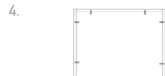
In Höhe von 17,8 cm über dem Boden in die Wände 6 Löcher mit 8mm Bohrer bohren. Holzdübel in Löcher stecken.
