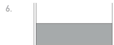
Sockelfront in 7 cm Höhe vorbohren. Seitenwände vorbohren. Unteren Sockelboden, Seitenwände und Sockelfront verschrauben. Oberen Sockelboden auf die Holzdübel und Sockelfront legen.
